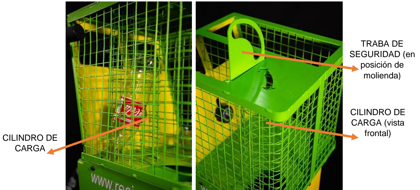
Figura 2. Detalles del canasto de operación.
